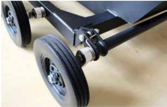
Das Leitrad verfügt über eine Kettenspannvorrichtung für den richtigen Zug
