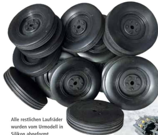
Alle restlichen Laufräder wurden vom Urmodell in Silikon abgeformt
