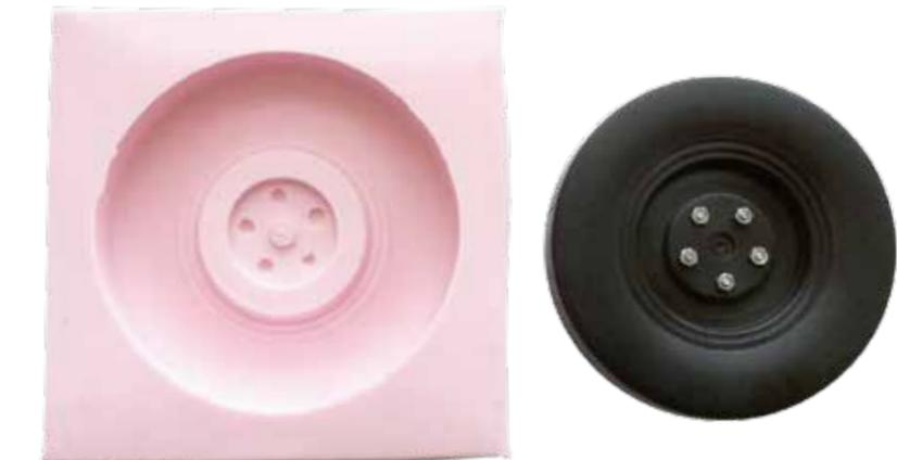
Das Urmodell der Laufräder wurde per CNC-Fräse gefertigt
