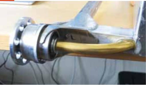
Der Antrieb wurde über flexible Wellen realisiert
