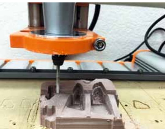
Fräsen der Tiefziehform auf der Stepcraft-Maschine
