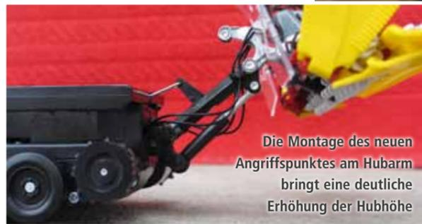
Die Montage des neuen Angriffspunktes am Hubarm bringt eine deutliche Erhöhung der Hubhöhe
