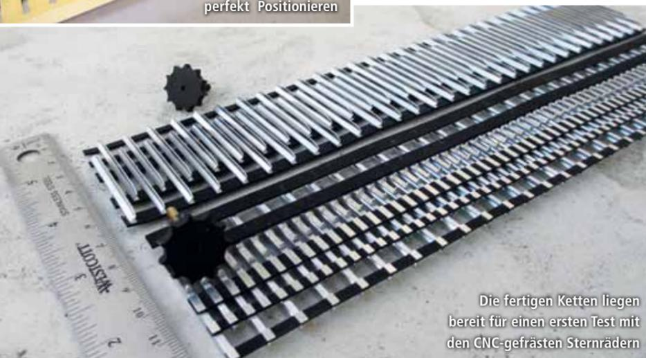
Die fertigen Ketten liegen bereit für einen ersten Test mit den CNC-gefrästen Sternrädern
