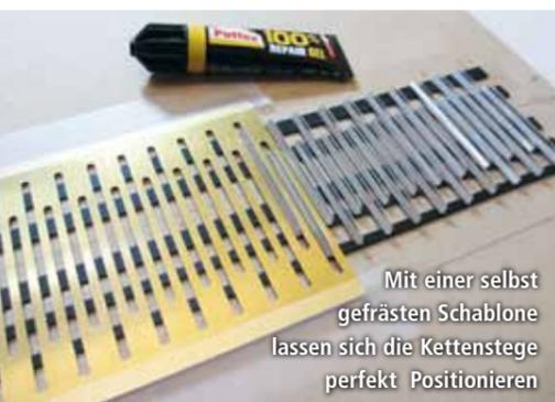
Mit einer selbst gefrästen Schablone lassen sich die Kettenstege perfekt positionieren
