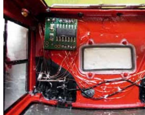
Der Einbau unter die Dachfläche verlangt noch einmal volle Konzentration. Die Kupferdrähte wurden dabei mit ein paar Tropfen Epoxykleber fixiert
