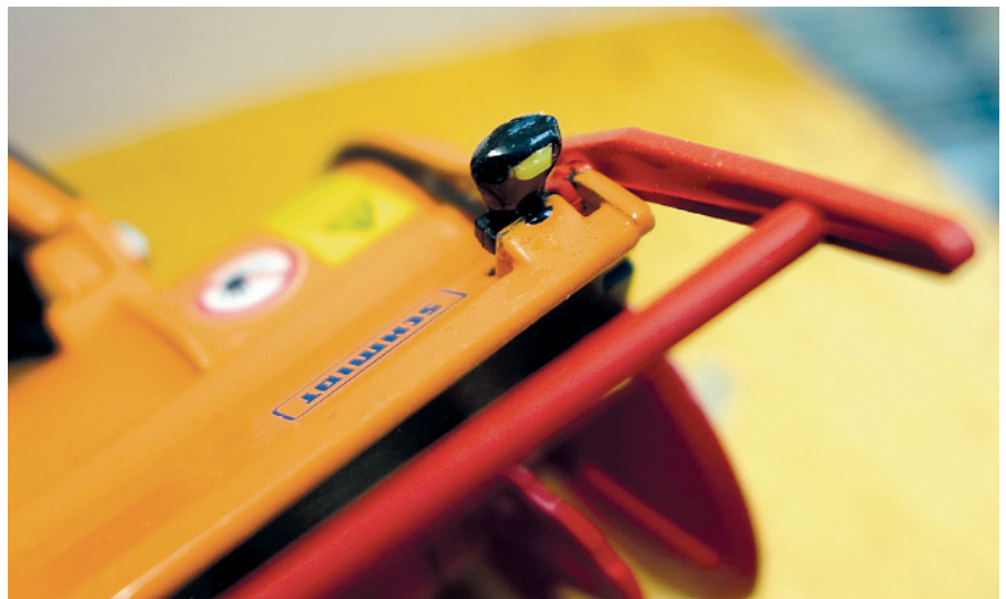
Die SMD-Leuchtdiode wird mit schwarz gefärbtem Harz eine Einheit mit dem Scheinwerfergehäuse
