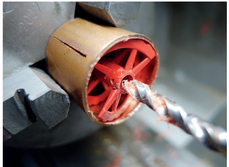
Das knifflige Aufbohren der Schälsschnecke kann entweder per selbstgebauter Spannzange in der Drehbank erfolgen...
