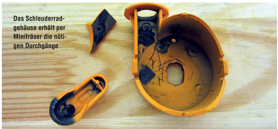
Das kleine Motörchen bei der Anprobe im Schleuderrad...
